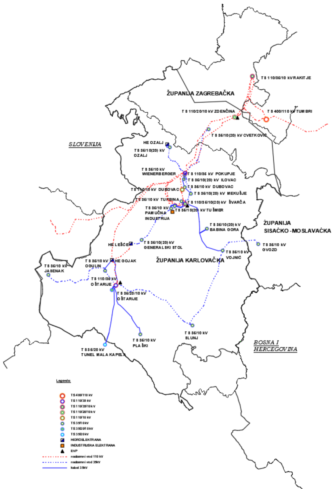
Slika 2. Topološki prikaz 110 kV i 30(35) kV mreže distribucijskog područja
