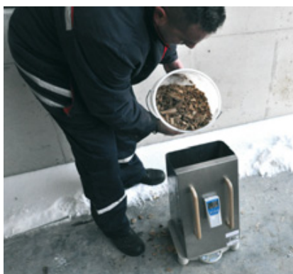
Sječka se stavlja u uređaj za mjerenje vlažnosti Humimeter BM1
