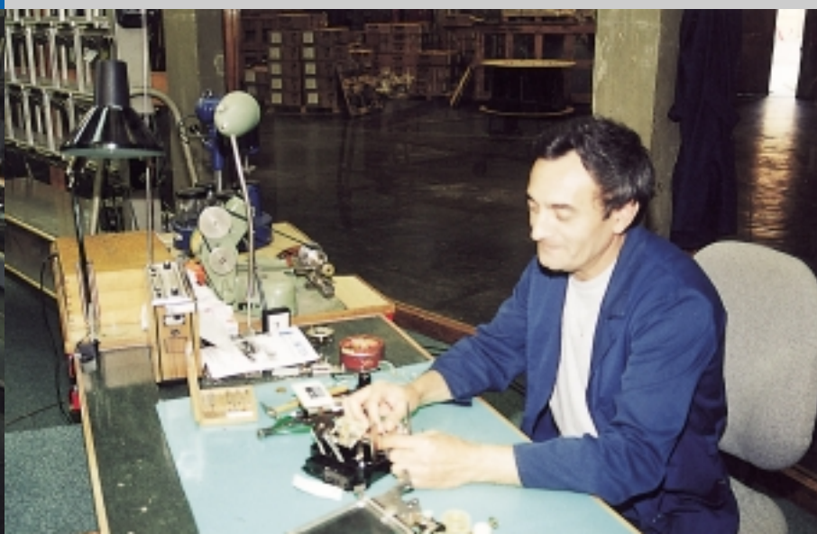
Ilija Jaman, VKV majstor i Slavko Flegarić, poslovođa Baždarnice Zlatko Ostrošić, VKV urar, umjerava brojila i uklopne satove
