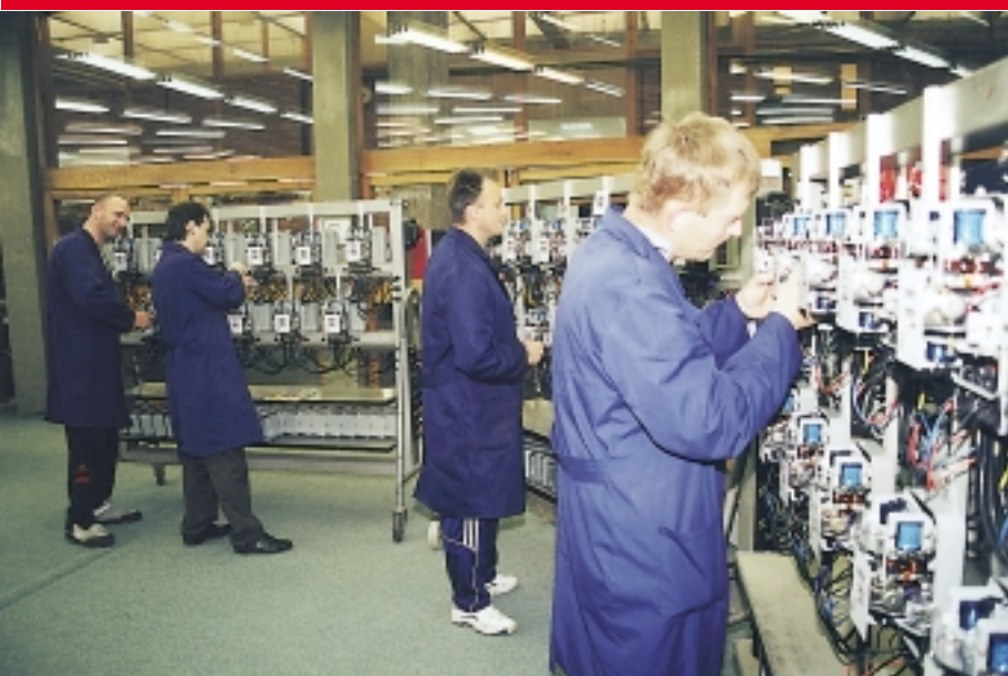
Stjepan Bačani, Borislav Romić, Gordan Lasić i Zoran Brkić umjeravaju brojila široke potrošnje Vlado Vedlin, majstor radio i TV elektroničar
