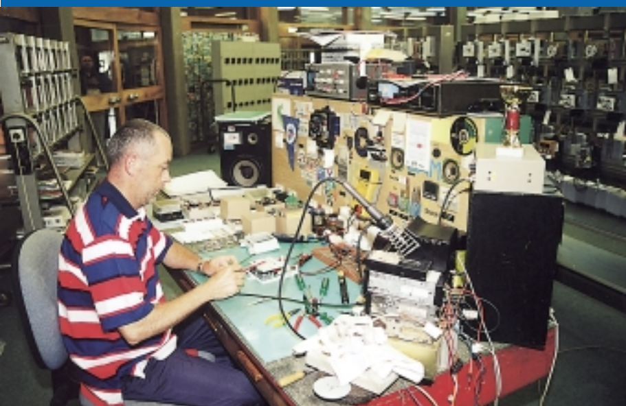
Stjepan Bačani, Borislav Romić, Gordan Lasić i Zoran Brkić umjeravaju brojila široke potrošnje Vlado Vedlin, majstor radio i TV elektroničar
