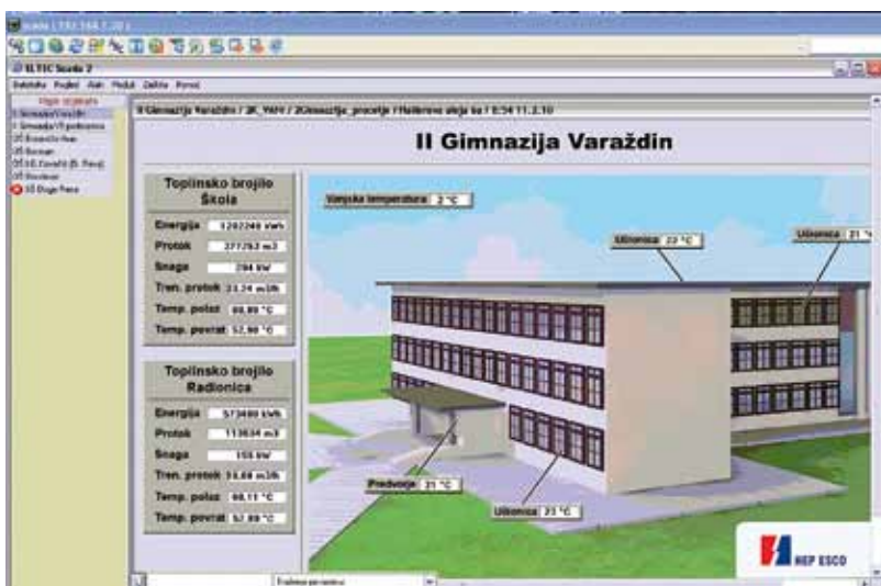
Ilustracija 6 ... i Varaždinu (sustav SCADA za praćenje energetske uštede u II. gimnaziji Varaždin u sklopu projekta HEP ESCO M&V)
