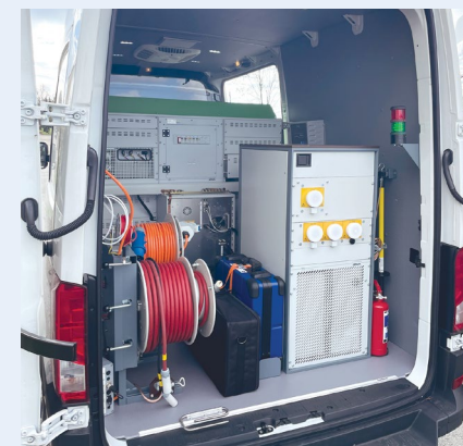
↑ Visokonaponski prostor u vozilu: generator ispitnog napona, priključni kabeli i ostala oprema
