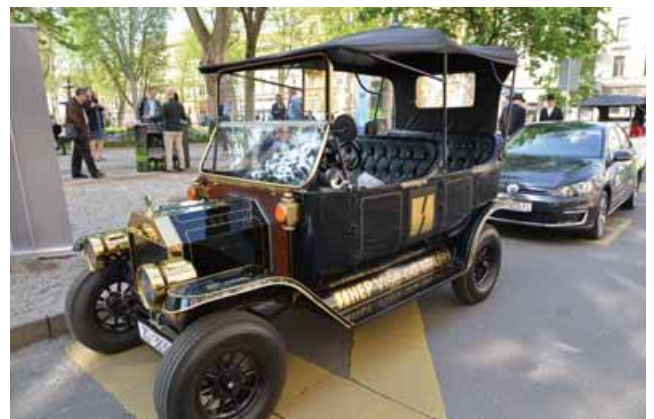
Replika Fordovog modela T s električnim motorom kreće se brzinom od 25 kilometara na sat i može prevesti četiri putnika
