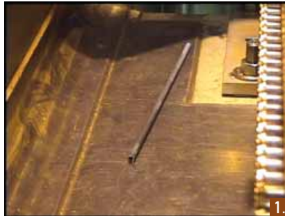
1. Odlomljeni dio gorivne šipke na dnu transportnog kanala pospremljen je u za to predviđeni kontejner u bazenu za istrošeno gorivo 2. Mehanička oštećenja otkrivena su na gorivnim elementima, koji su proteklih 18 mjeseci bili na rubnim lokacijama u reaktorskoj jezgri
