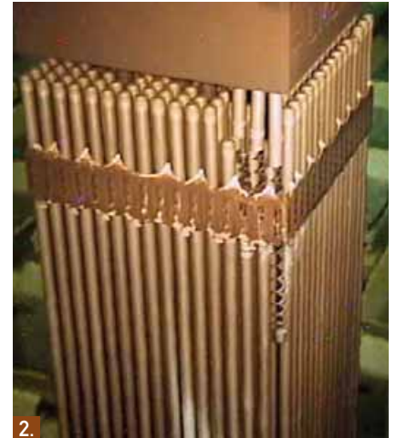
1. Odlomljeni dio gorivne šipke na dnu transportnog kanala pospremljen je u za to predviđeni kontejner u bazenu za istrošeno gorivo 2. Mehanička oštećenja otkrivena su na gorivnim elementima, koji su proteklih 18 mjeseci bili na rubnim lokacijama u reaktorskoj jezgri
