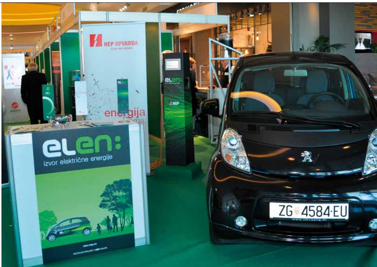
Izložbeni prostor HEP Opskrbe s vozilom Peugeot Ion (s električnim motorom snage 47 kW/67 KS i baterijom kapaciteta 16 kWh) raspoloživ za vožnju i njegovo punjenje zainteresiranih posjetitelja. (njegova je brzina 130 km/h, potrebno vrijeme punjenja na brzim punionicama do pola sata te s jednim punjenjem može prijeći 130 km)
