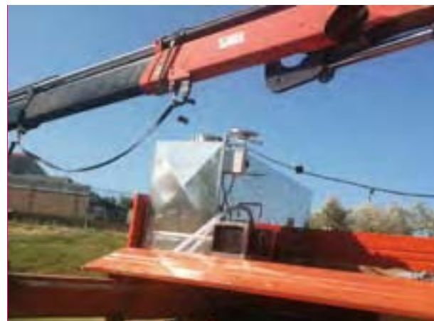
Spremnik vode od inoksa (prokroma) ugrađen kao dodatna oprema postojećeg terenskog višenamjenskog vozila Unimog
