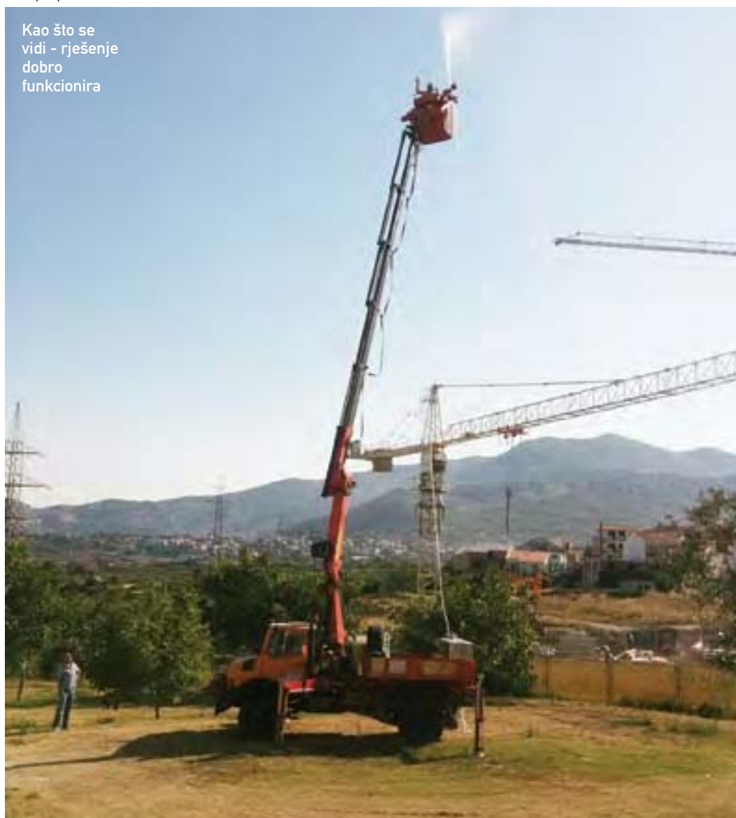
Spremnik vode od inoksa (prokroma) ugrađen kao dodatna oprema postojećeg terenskog višenamjenskog vozila Unimog
