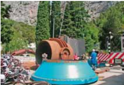
Dijelovi predturbinskog kuglastog zatvarača, koji će biti obnovljen u Litostroju
