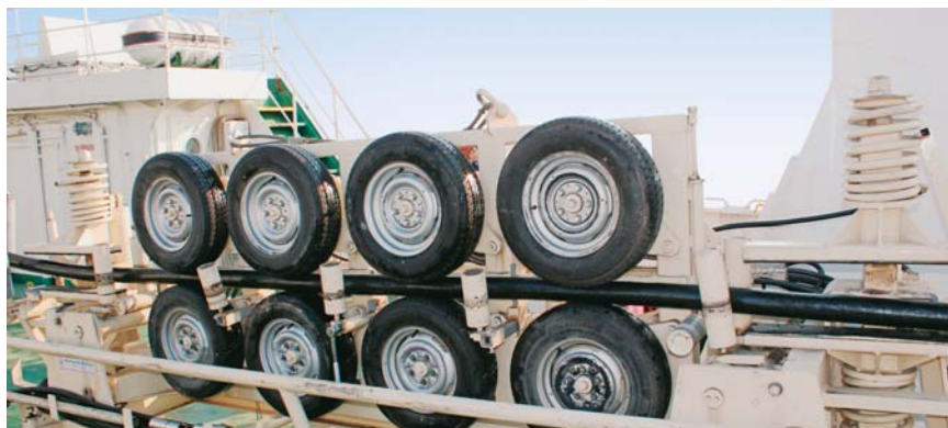
Posebna, originalna, sprava izrađena za polaganje kabla u vrijeme Otočne veze i danas dobro funkcionira, a ako se pitate zašto su upotrijebljene automobilske gume, odgovor je vrlo jednostavan: da ih se lako može zamijeniti novima kada se pohabaju
