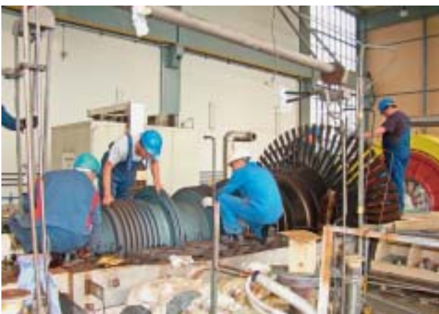
Provjera toplinske zračnosti u protočnom dijelu turbine
