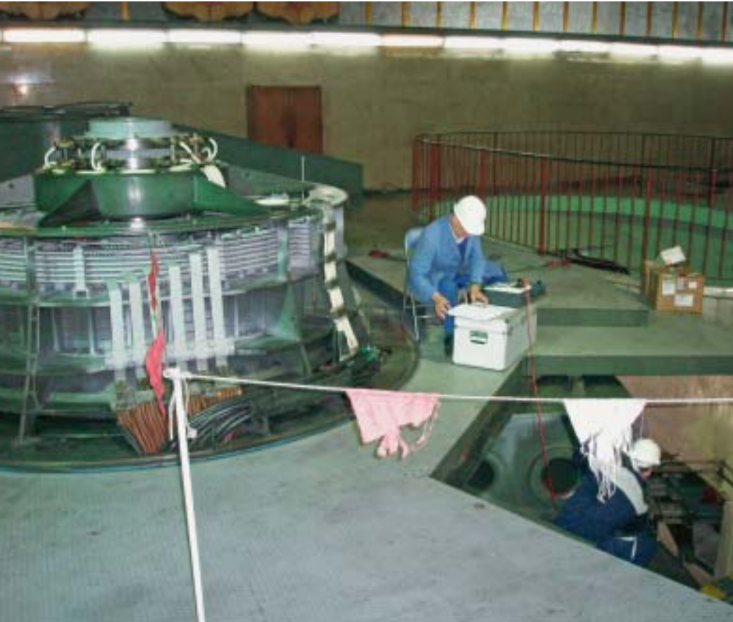
Redovno godišnje ispitivanje generatora obavljaju zaposlenici Končar Instituta za elektrotehniku
