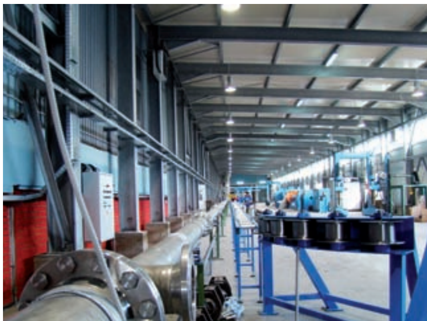
Linija za proizvodnju srednjonaponskih i visokonaponskih kabela u novoizgrađenoj hali tvrtke Elka
