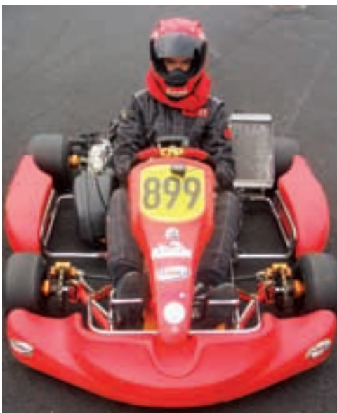
Borna u svojoj pili- MS Kart Rotax , DD2, 125 kubika, 34 KS, 100 kg
