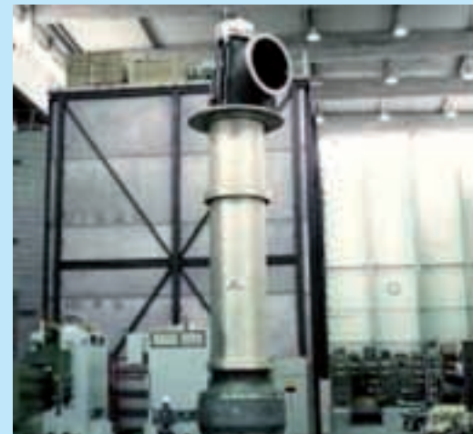
Odabrana KSB crpka koja će biti ugrađena tijekom rekonstrukcije CSRV
