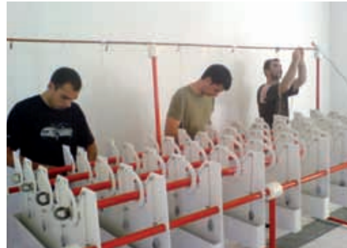
Studenti ETF-a Osijek na stručnoj praksi u Kontrolno-ispitnom laboratoriju HEP NOC-a pripremaju ispitne uzorke i postavljaju visokonaponske elektrode
