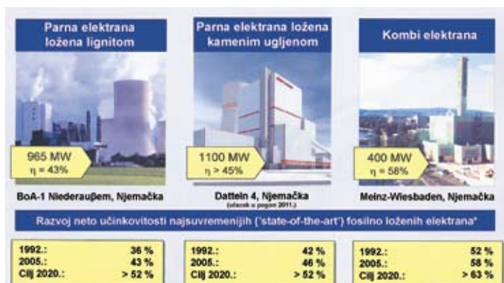
Razvoj neto učinkovitosti najsuvremenijih fosilno loženih elektrana *odnosi se na doljnu ogrjevnu moć
