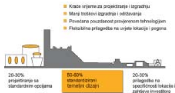
Slika 8. Kraće vrijeme izgradnje i manje pogreške pri izradi opreme i pogonu izgradnjom modularne elektrane
