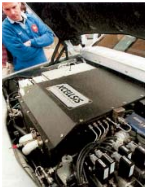
Motor s gorivim ćelijama pokusnog vozila u centru za razvoj DaimlerChryslera
