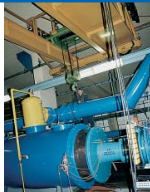
Stanica za ispitivanje cijevnih turbina kakve imaju HE Dubrava i HE Čakovec. Sada je na ispitivanju model za HE Bhavani u Indiji
