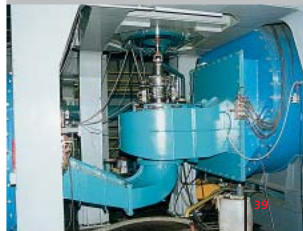
Stanica za ispitivanje Kaplan turbina kakve koriste HE Varaždin, HE Đale, HE Ozalj 2...
