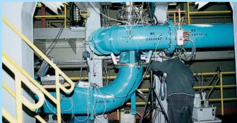
Model 2 turbine bez rotora HE Zakučac 1 na ispitnoj stanici za Francis turbine simulira rad od ulaza u spiralu do izlaza u difuzor
