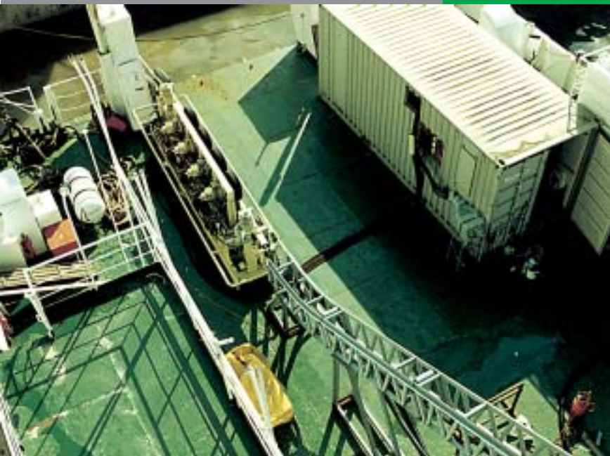
Gusjenica i žirafa namataju kabel pri utovaru na trajekt
