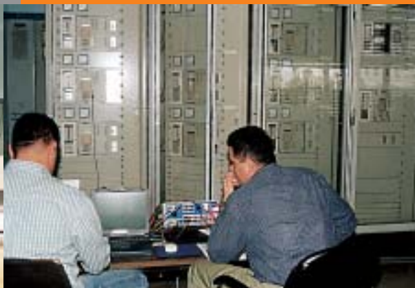
Ispitivanje sustava relejne zaštite: Josip Filković i Renato Turk
