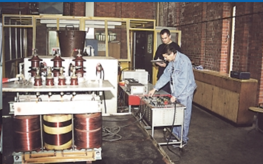
Antun Vrtarić i Krešimir Tačković pri ispitivanju transformatora
