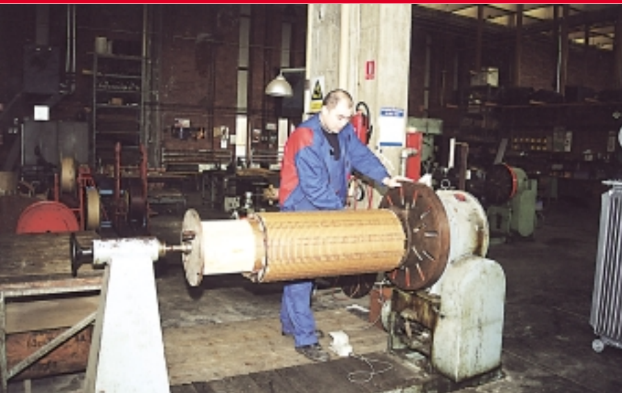
Izrada namotaja za transformator 2,5 MVA, 35/10 kV i Gordan Knežević
