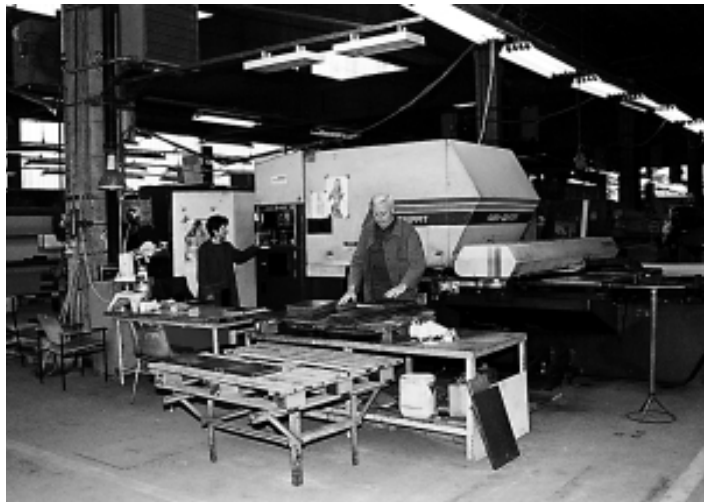
Bazne tehnologije u proizvodnji TEP-a su obrada lima na numeričkim strojevima, prerade plastike metodom injektiranja i prešanja
