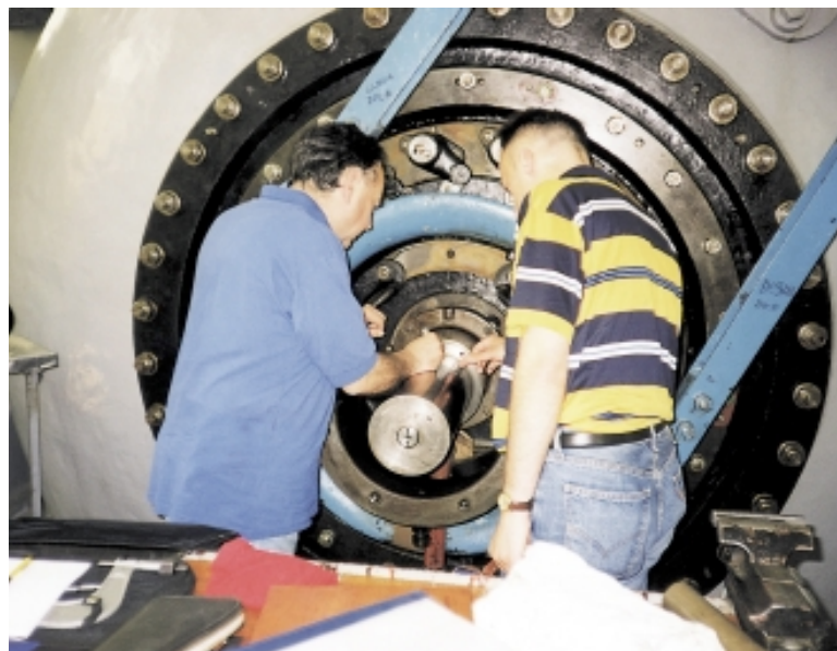
... defektaža rukavca osovine na mjestu visokotlačnog ležaja...
